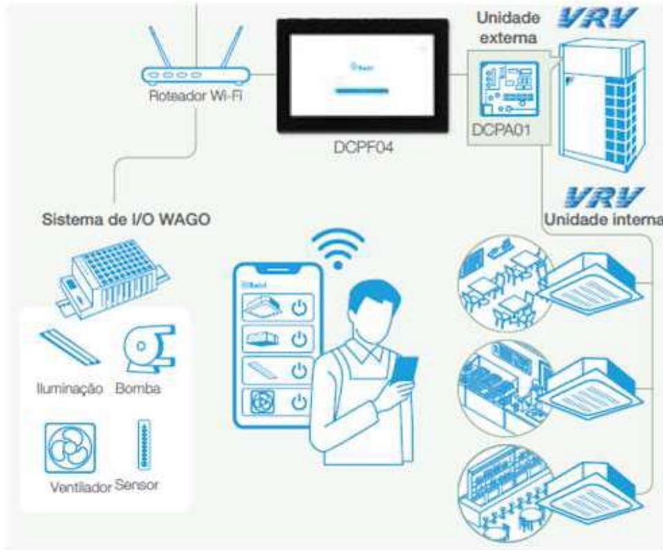
O sistema de automação projetado preverá o controle de todo o sistema de climatização do edifício a partir do gerenciador central, controlando e monitorando de forma independente ou em grupo todos os equipamentos integrantes do sistema.
