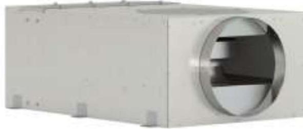
Os ambientes receberão suprimento de ar externo mecanicamente, por intermédio de caixas de ventilação de acionamento temporizado e/ou manual, atendendo aos parâmetros estabelecidos em projeto e nos normativos técnicos vigentes. Sucintamente compostas por gabinete e conjunto moto ventilador, conforme a descrição pormenorizada que segue:
