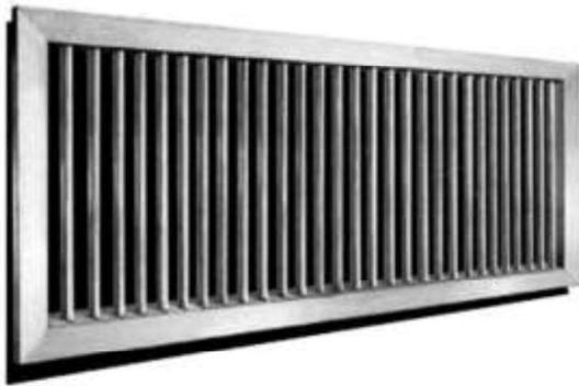
As grelhas de insuflamento de ar externo serão fabricadas em alumínio, submetido a tratamento anticorrosivo. Disporão de aletas com simples deflexão a registros para ajuste e balanceamento das vazões de ar, em conformidade as definições de Projeto.
